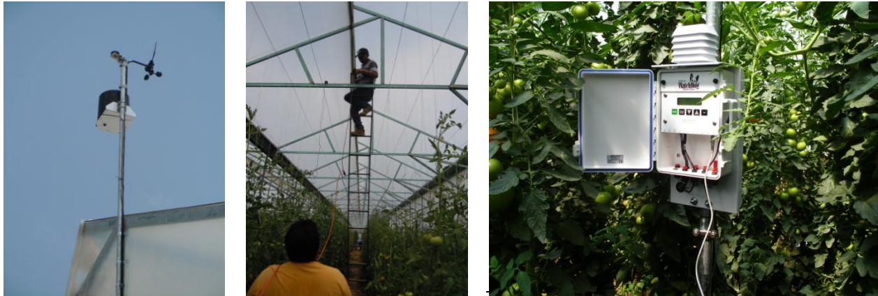
Figura 1. Anemómetro, veleta, pluviómetro y piranómetro afuera del invernadero (izquierda); piranómetro (en medio), caja de instrumentación y sensores de temperatura y humedad relativa (derecha) adentro del invernadero.
