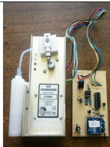
Figura 11. Sistema ozonosonda-interfase terminado
